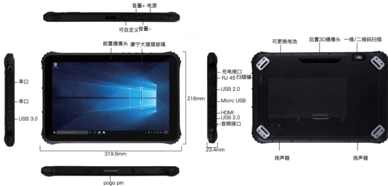
GPC-H122X是一款二合一坚固三防笔记本,支持windows10操作系统,安全性高,操作方便;采用Intel Cherry trail Z8350处理器,性能大幅度提升,优化工作效率和性能。12.2英寸高清IPS屏,配备3.7V/12600mAh可拆卸聚合物锂电池,提升机器续航能力,保证工作时长与延续。
