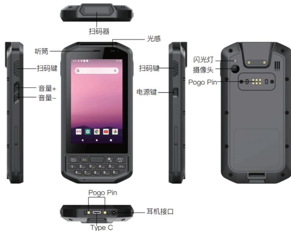
GPC-G04是一款三防手持终端，支持Andriod 9.0操作系统,安全性高，操作方便;采用MSM 8953 八核处理器，性能大幅度提升，优化工作效率和性能。4寸5点 电容屏，配备3.85V/4000mAh内置聚合物锂离子电池，提升机器续航能力,保证工作时长与延续。
