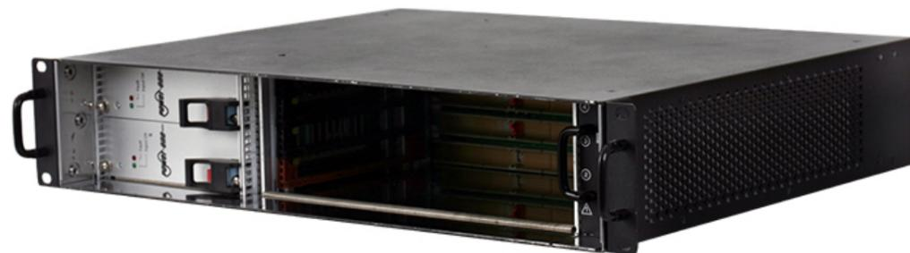
CPC-6028是一款2U 4槽19" 标准上架式CompactPCI机箱, 1个系统槽、3个扩展槽,支持前后插卡, 符合PICMG2.0、PICMG2.1、PICMG2.5技术规范。采用可插拔风扇模块, 从右到左吹风式散热设计, 进风口安装防尘网, 更换方便。该产品可靠性高, 适用于地面通讯系统、服务器等领域。
