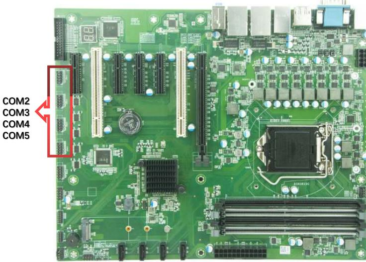
如上图，图中标注COM2~COM5，插针间距2.54mm；
