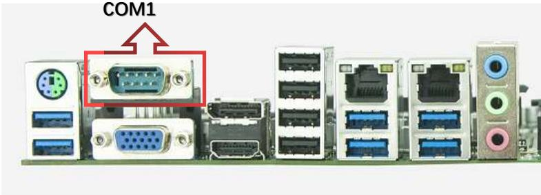
如上图，图中标注COM1，标准DB9母头公座，可用于连接RS232协议的外设,根据需求，可选择通过跳冒JP1\JP2\JP3 来切换RS422/485模式。
