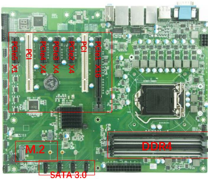
▷ 内存：DIMM DDR4插槽
