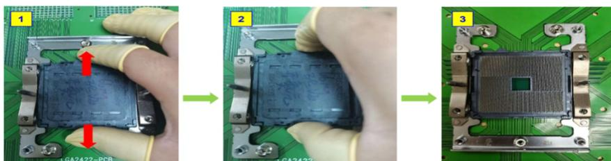
2. 将 CPU 对准 CPU 插槽 Pin1 轻轻放入
